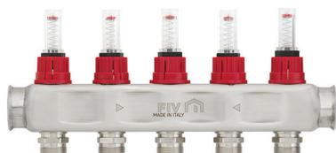
Colector de envío de acero inoxidable AISI 304 con acabado cepillado, de 1" - derivación 24x19 SIN vía adicional, con detentores con medidores de capacidad incorporados 0÷4 l/ min. y conexiones adicionales para válvula de ventilación y grifo de descarga.
