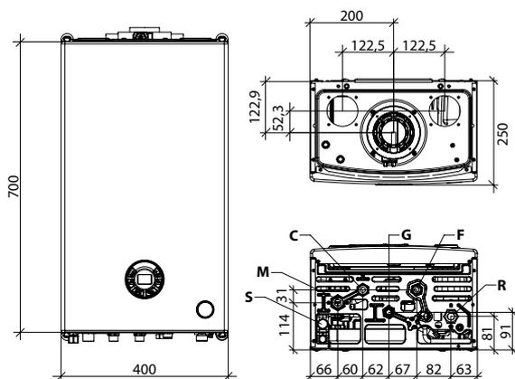
**S** Descarga de condensado
